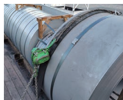
ワイヤー・ロープ使用の際の 横ズレ・傷防止に
