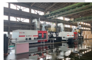
成形工程 (生産能力 18,000個/基×4基=72,000個/月)
