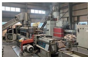
原料ペレット製造(最大450t/月)
